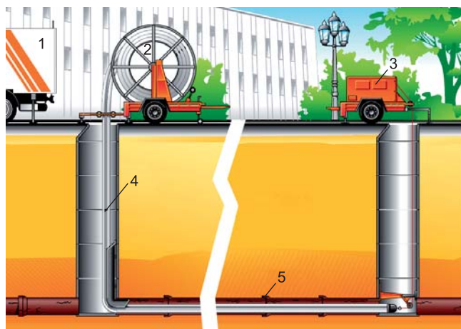
Рис. 13. Процесс установки полиэтиленового рукава по технологии «Compact Pipe»
