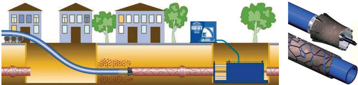
Рис. 16. Протяжка полиэтиленовой трубы с разрушением существующего трубопровода
