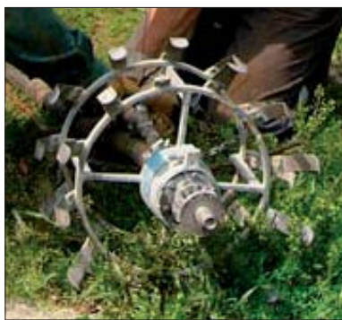
Рис. 3. Устройство для промывки трубопровода водой под давлением
