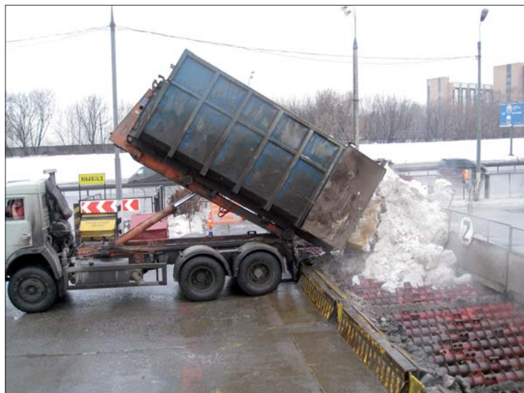
Рис. 3. Прием снега на снегосплавном пункте
